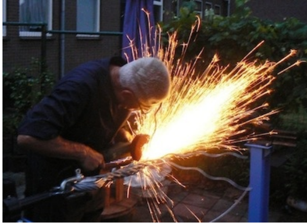
Hans van der Haar werkt aan de staalkabels van het hijstuig van de Terra Nova.
