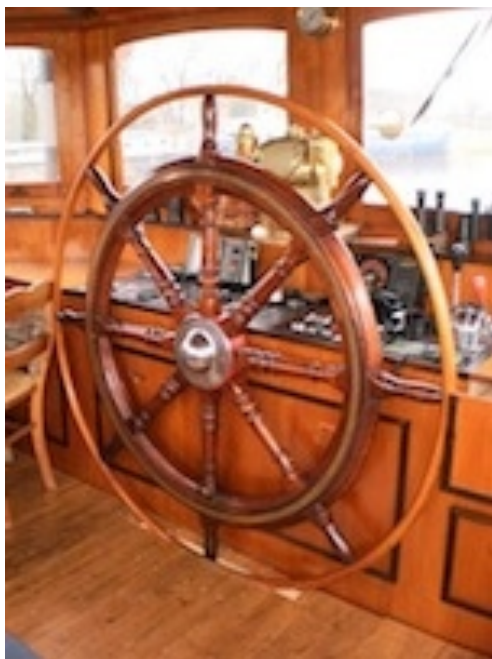
Het originele stuurwiel waarvoor wel een gleuf in de vloer moest worden gemaakt.
